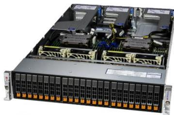
A família de servidores NEXUS rack de duas via, está direcionada para quem procura uma solução robusta, com níveis de performance elevados e que permita crescer de forma flexível. Com suporte para dois processador AMD® Epyc Turim, 24 slot's DDR5, 24 gavetas hotswap com capacidade de suporte para SSD NVME, fazem desta gama de servidores uma excelente escolha para as emprsas que procuram performance de topo, De base módulo de gestão remota com suporte iKVM
